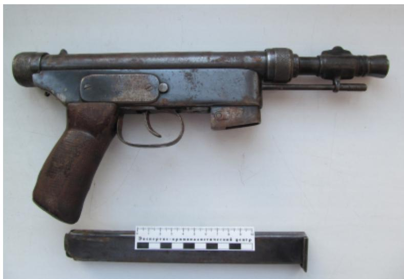
Рисунок 2 – Один из вариантов конструктивно сходных с пистолетом-пулеметом К6-92 самодельных пистолетов-пулеметов «Борз» (без магазина) под патрон 9х18 мм (ПМ)
