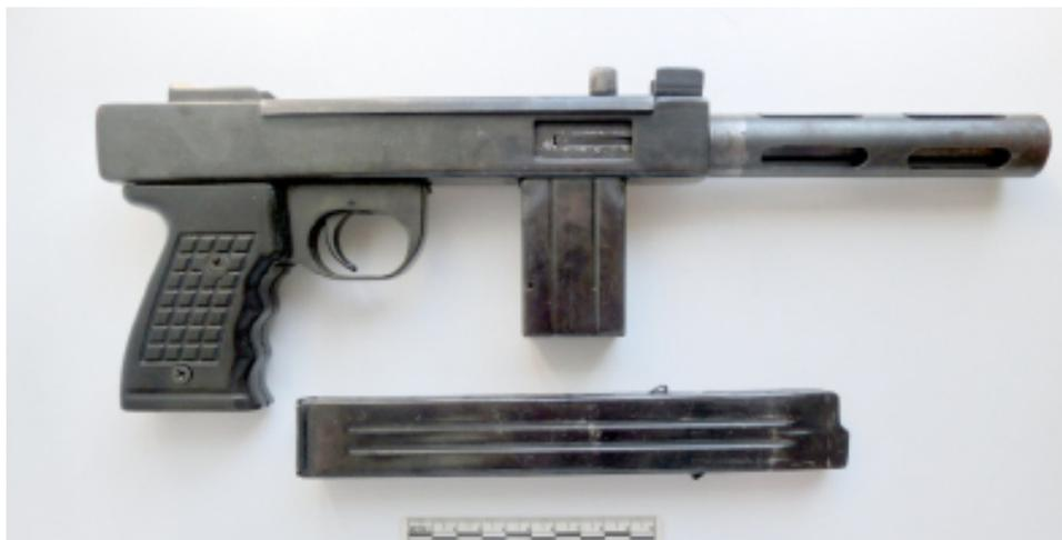
Рисунок 3 – Представленный на исследование самодельный пистолет-пулемет под патрон 9х18 мм (ППМ)
