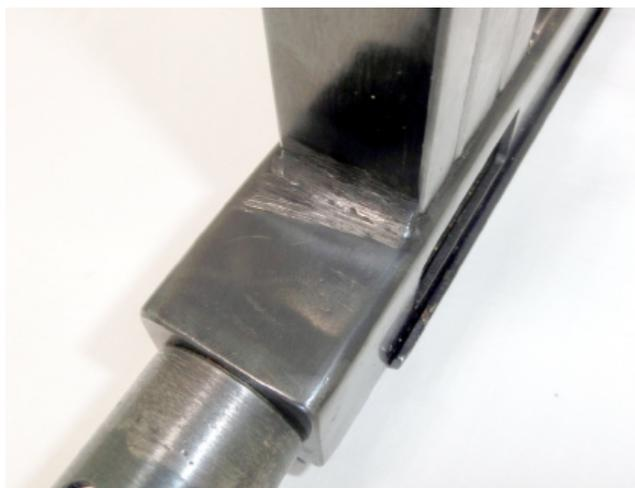
Рисунок 6 – Сварной способ соединения горловины магазина к затворной коробке
