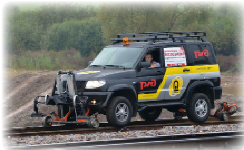
Рис. 2. Автомобиль УАЗ Патриот на комбинированном ходу Picture 2. Hybrid road-rail UAZ Patriot
